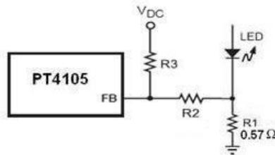
当DC电压增加时LED电流减少，反之LED电流增加。如 $V_{DC}$ 电压变化范围为 0—5V，则R2 和R3 满足 1: 24 的比例关系，可分别取 5K  $\Omega$  和 120K  $\Omega$ 。
