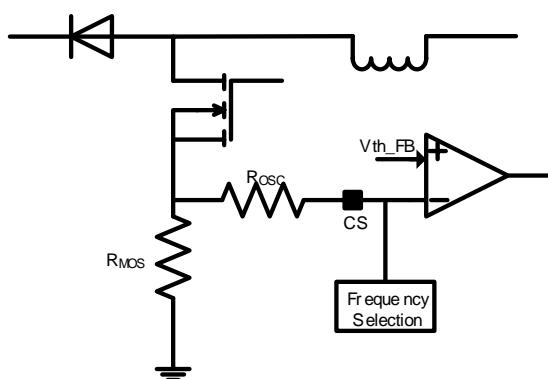
PT4132 有三种工作频率可以设置。在 PT4132 给 VIN 上电时，芯片通过检测连接至 CS 引脚的电阻阻值来选择不同的工作频率。
